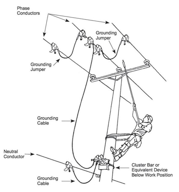
Figure 5 - Equipotential Grounding for Wood Poles
